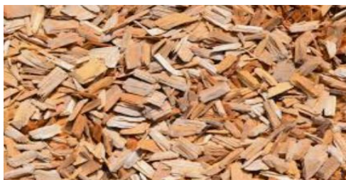
Fot6. Nawierzchnia ze zrębki.
